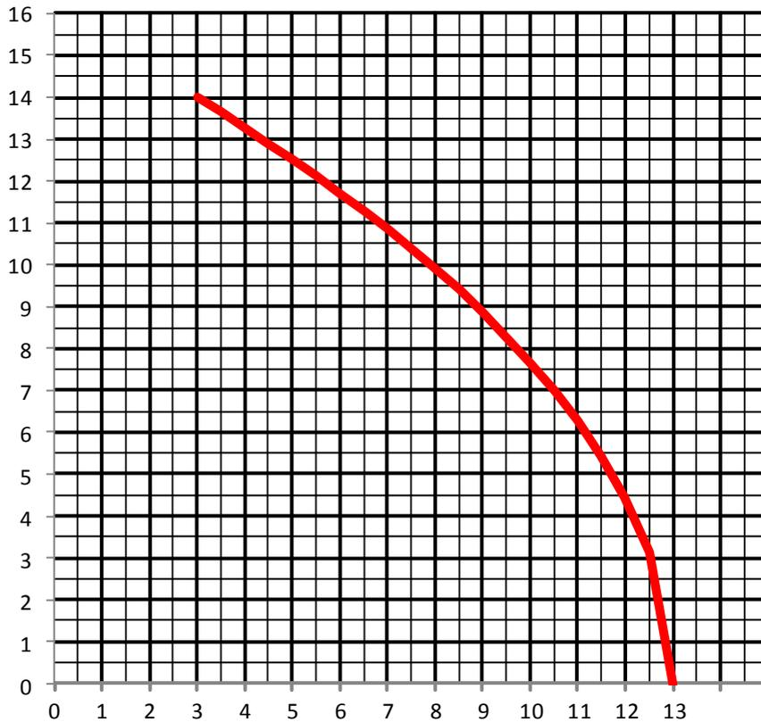
Vitesse d'écoulement en fonction de la hauteur d'eau dans l'écluse
